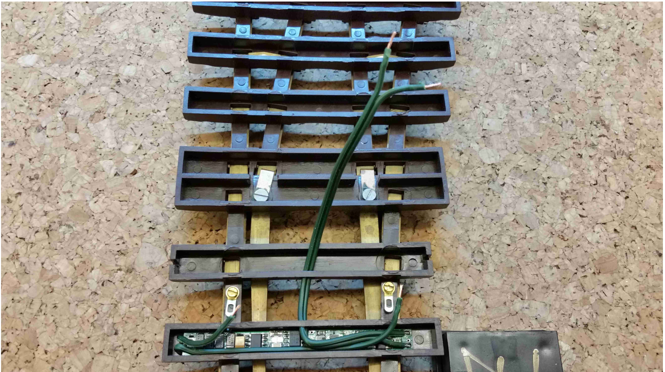
Abbildung 15: Abisolieren und Verzinnen
